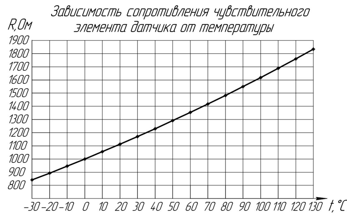
1. Диапазон измеряемых температур от минус 30 до плюс 130 $^\circ\text{C}$ .
