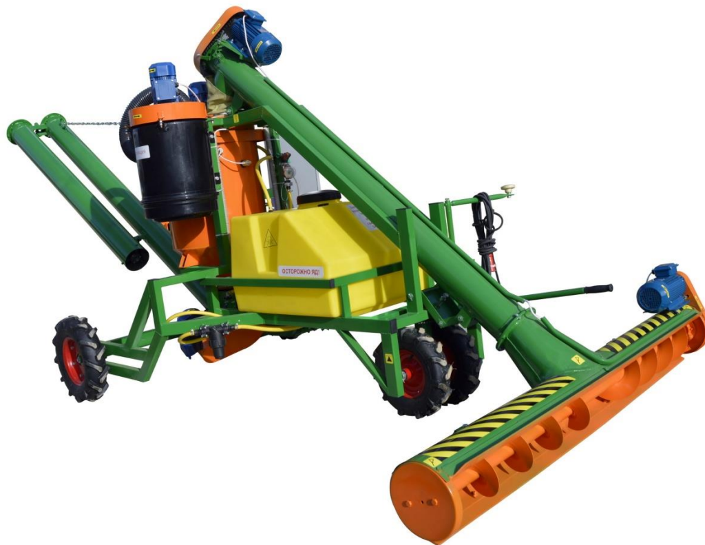
Рисунок 4.1 Протравливатель семян камерный ПСК-15М со складным шнеком.
