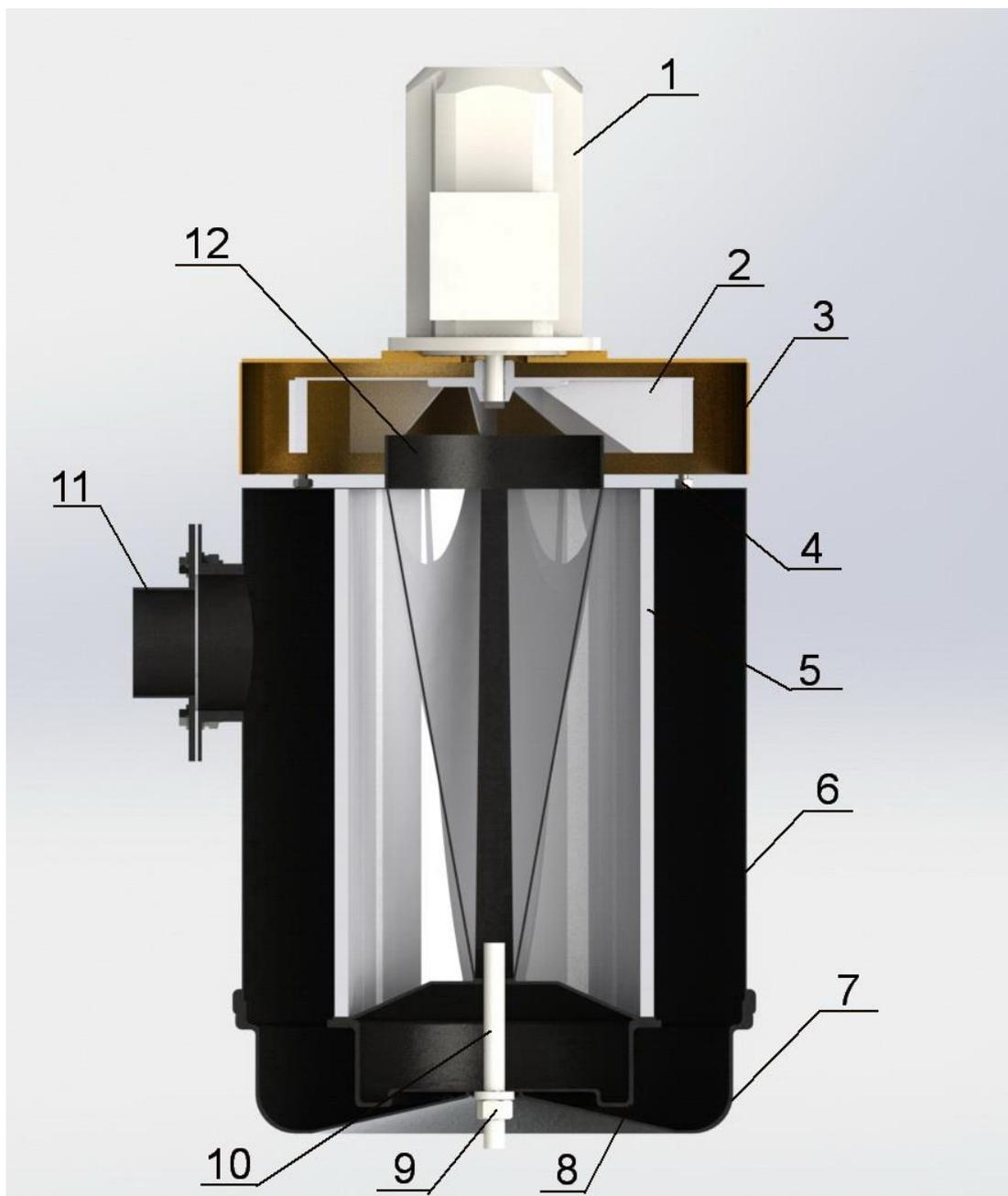
**Рисунок 5.6 Устройство фильтра аспирационной системы:**
