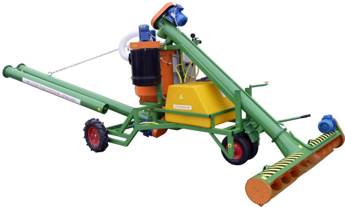
Рисунок 4.1А Протравливатель семян камерный ПСК-15 со складным шнеком.
