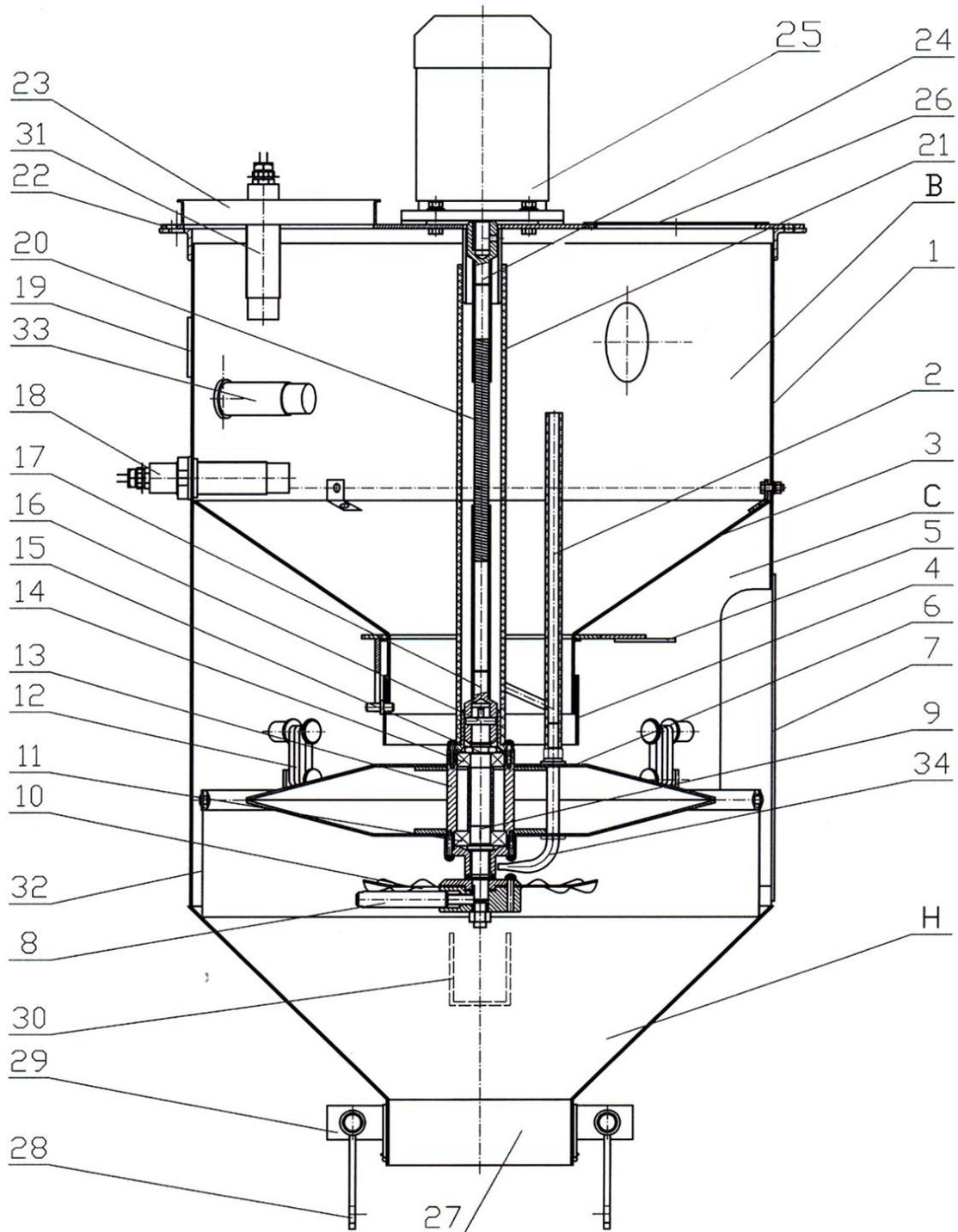
**Рисунок 5.1 Модуль дозированного смешивания (МДС):**
