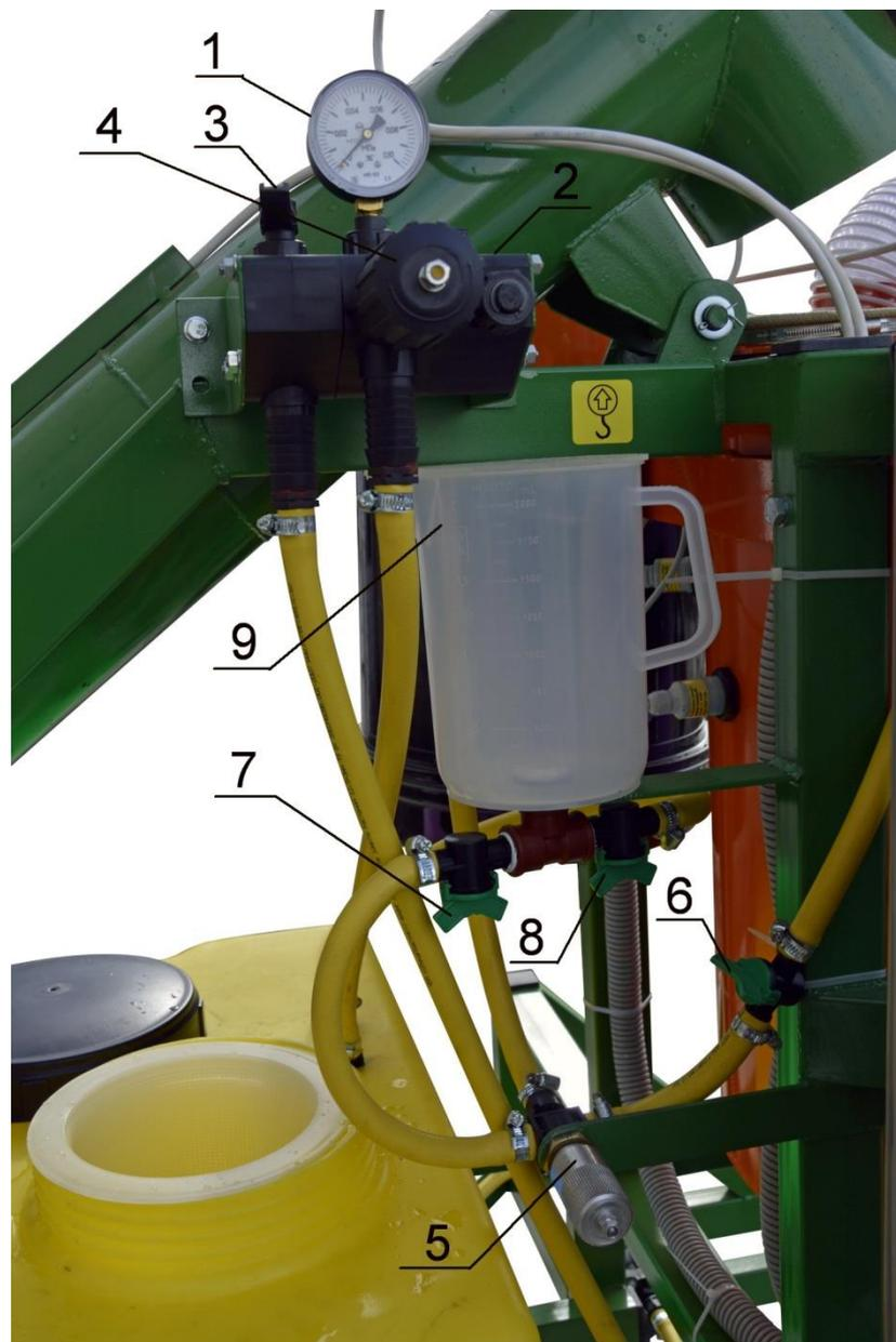
Рисунок 8.1 Система дозирования раствора:
