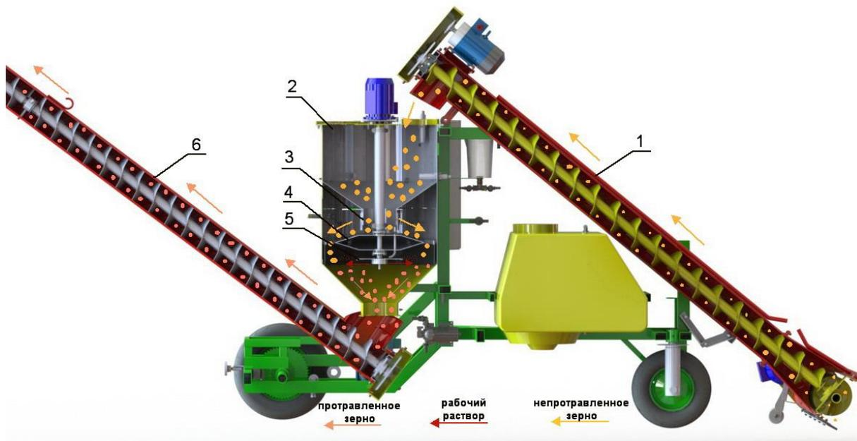
**Рисунок 4.2 Технологическая схема протравителя.**
