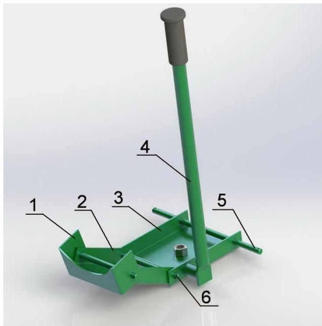
**Рисунок 5.8 Механизм подъема загрузочного шнека:**
