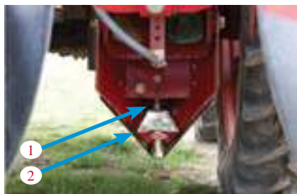
Рис. 2 Распределительное устройство в сошнике: 1 — тукопровод, 2 — распределительное устройство
