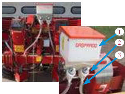
Рис. 1 Емкость для гранулята: 1 — емкость (бак) для гранулята, 2 — регулируемые катушки дозирующего аппарата, 3 — тукопровод
