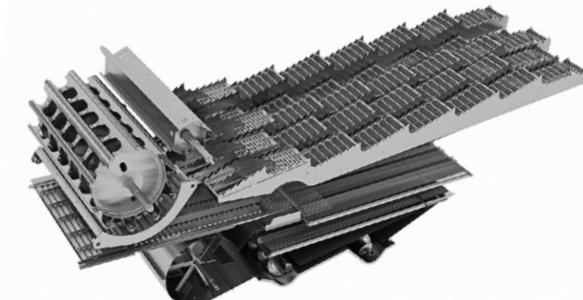
из кабины можно производить все необходимые регулировки потока воздуха и положения решёт. Кроме того, для удобства обслуживания решета легко снимаются.
