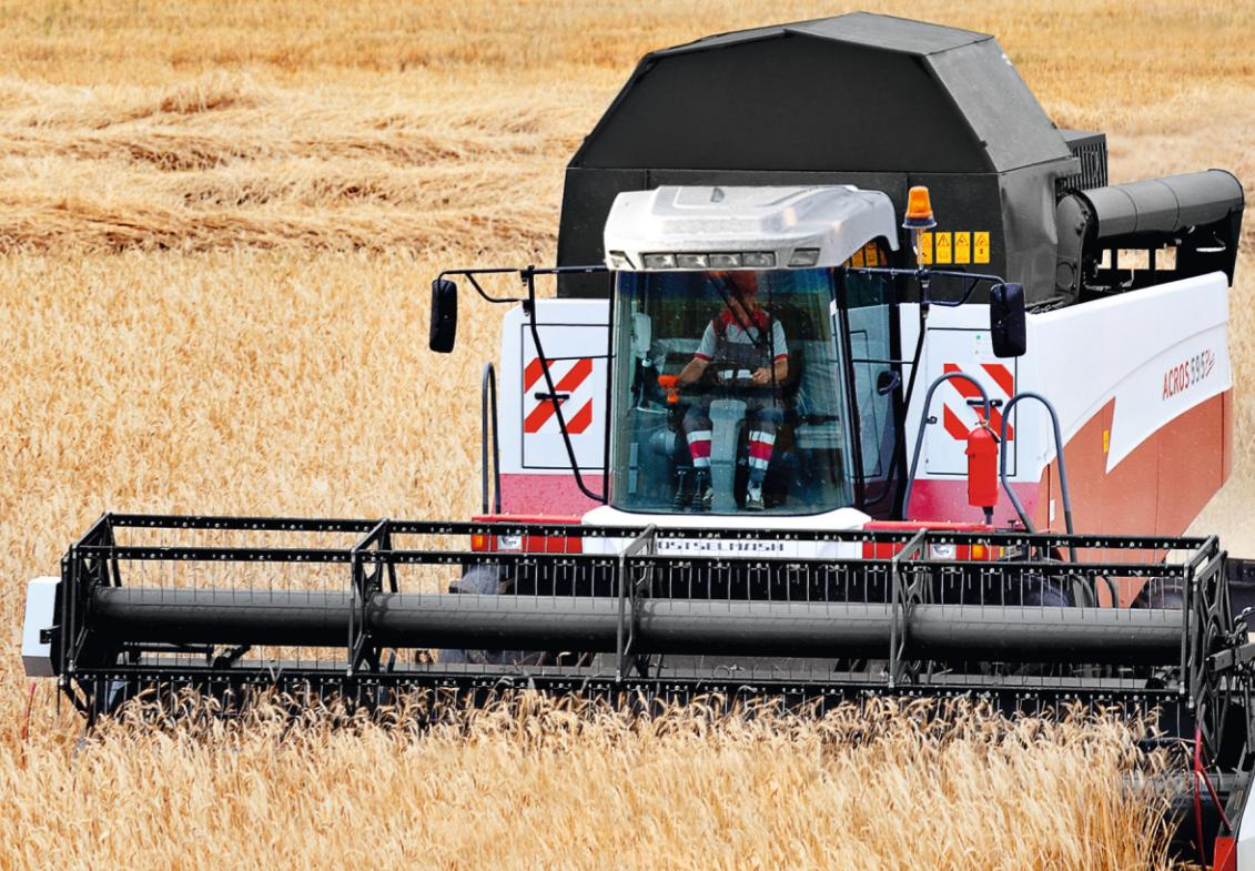
**Comfort Cab II** – подпрессоренная, герметизированная, двухместная кабина с аудиоподготовкой, усиленной шумоизоляцией, оборудованная кондиционером, отопителем, охлаждающей камерой.
