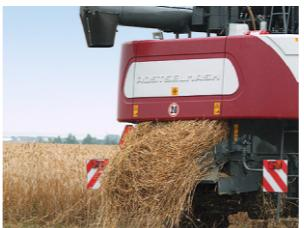
Измельчитель-разбррасыватель комбайна ACROS 595 Plus существенно отличается от такого для младших моделей. Переключатель режима «измельчение-валок» переместился на заднюю стенку измельчителя и при укладке валка масса выходит не против, а по ходу движения комбайна, через окно в капоте. Такая технологическая схема предпочтительнее, поскольку при остановке комбайна в режиме «укладка валка» масса не скапливается под измельчителем.
