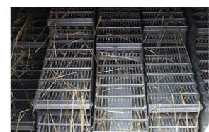
Для повышения производительности увеличена длина клавиш (+120 мм) и изменена поверхность клавиш. Модернизированные пазы на поверхности клавиш расположены не попрёк движения массы, а вдоль и в виде ступенек, что способствует лучшему просыпанию зерна при высоких транспортирующих свойствах клавиш. Соломотряс в новом исполнении обеспечивает более интенсивный процесс сепарации, особенно, в условиях повышенной влажности.
