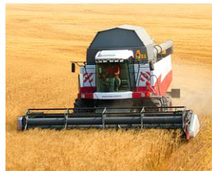
При работе на ACROS 595 Plus комбайнеру не нужно торопиться, если пойдёт дождь и рядом не окажется машины для выгрузки. Всё бункерное зерно будет надёжно закрыто специальным фартуком. Также благодаря такому устройству мелкосеменные культуры, подверженные выдуванию, будут оставаться внутри, независимо от силы и направления ветра.
