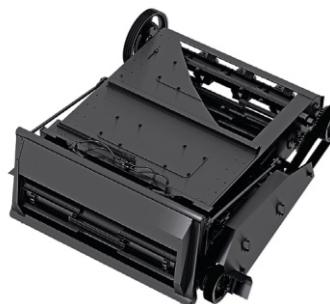
В наклонной камере использовано уникальное решение: на выходе транспортера установлен битер-ускоритель. Теперь вся хлебная масса, движущаяся в сторону молотильного барабана, не только разравнивается, но и ускоряется. В результате снизились динамические нагрузки на молотильную систему, увеличилась ее пропускная способность.
